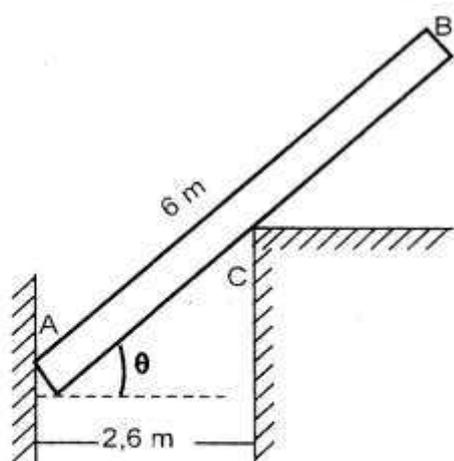
En la figura, la viga AB de 100[N] tiene su centro de gravedad en el punto medio de su longitud. La reacción en C es perpendicular a la viga y la pared vertical de la izquierda es lisa. Determinar el valor de  $\theta$  para que la viga esté en equilibrio.
