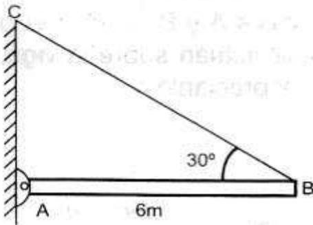
9. La viga homogénea de la figura, tiene un peso de 400[N]. Determinar:
