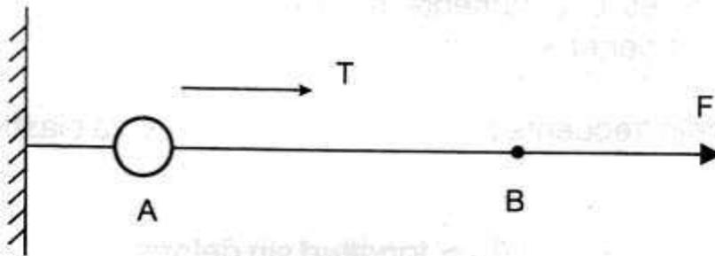
La aplicación de una fuerza  $F$  al extremo  $B$  de la cuerda, determina que en el punto  $A$  la cuerda transmita una fuerza (tensión) a la pared.
