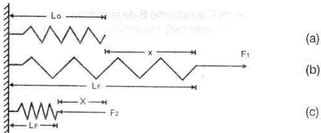
Si se comprime el resorte mediante la aplicación de la  $F_2$ . fig (c), tratará de volver a su longitud natural, al generar una fuerza elástica  $F_e$  hacia tal posición.
