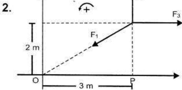
En la figura  $F_1 = 10[\text{N}]$ ,  $F_2 = 5[\text{N}]$  y  $F_3 = 12[\text{N}]$ . Calcular el torque resultante con respecto a los punto O y P.
