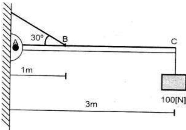
La viga homogénea de la figura tiene un peso de 500 [N] y está articulada en A. Determinar:
