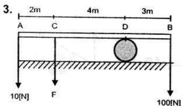
El sistema de la figura está en equilibrio. Si el peso de la varilla: AB es despreciable, determinar:
